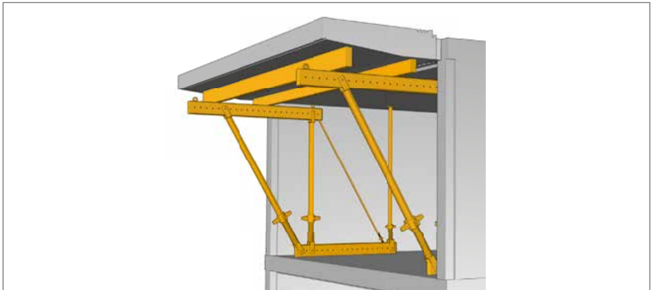
Kuva 138: Schöck IDock®: Vaihtoehtoisesti, elementtiparvekkeen tuenta alla olevaan välipohjaan
